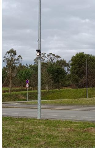
Este equipamento permite recolher dados essenciais, com vista a avaliar as condições atmosféricas e a propagação de odores para o exterior.
